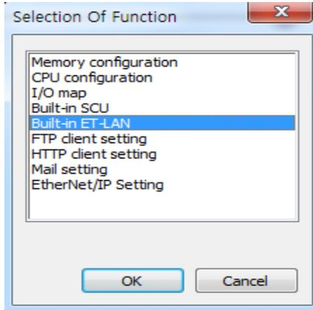
2. Built-in-LAN 을 선택하여 Built-in-LAN Setting 창을 팝업합니다.
