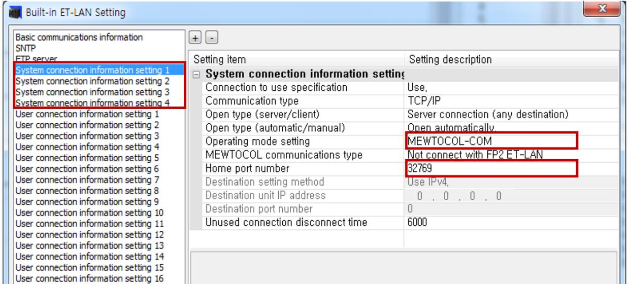
MEWTOCOL-COM,MEWTOCOL7-COM,MODBUS-TCP,MEWTOCOL-DAT,MC protocol 이 있으나 TOP 은 MEWTOCOL-COM 만 지원합니다. PLC 포트를 맞춰줍니다
