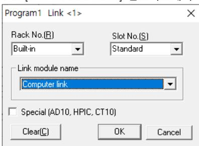
4. [Link parameter setup] 다이얼로그 창으로 돌아와 [Detail]버튼을 클릭하여 [Computer link P1 L1 Rbuilt-in SL1] 다이얼로그 창을 팝업하여 시리얼 통신 파라미터를 설정합니다. 국번으로 8 진법 숫자를 입력합니다. 외부 장치의 진법에 맞춰 TOP 에서 국번 설정시 10 진수 숫자를 입력하십시오.
