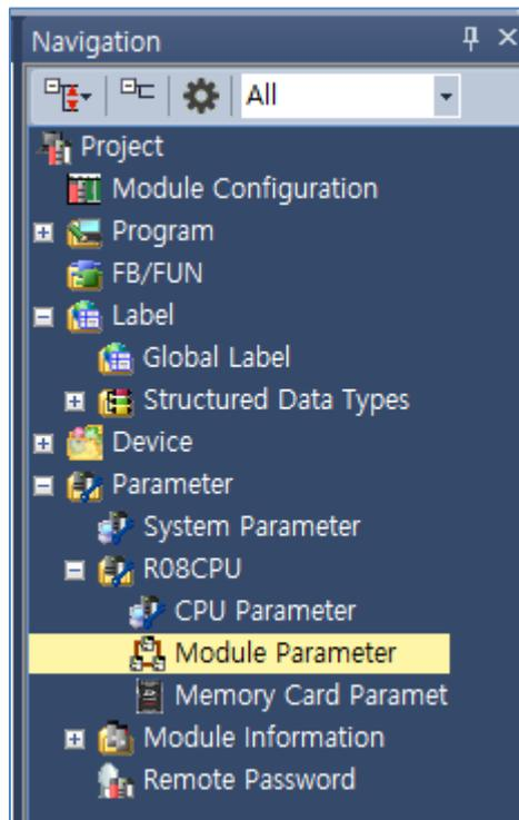
**Step 2.** [Module parameter] 창에서 [Basic Settings] 탭을 선택하여 아래 내용을 설정합니다.
