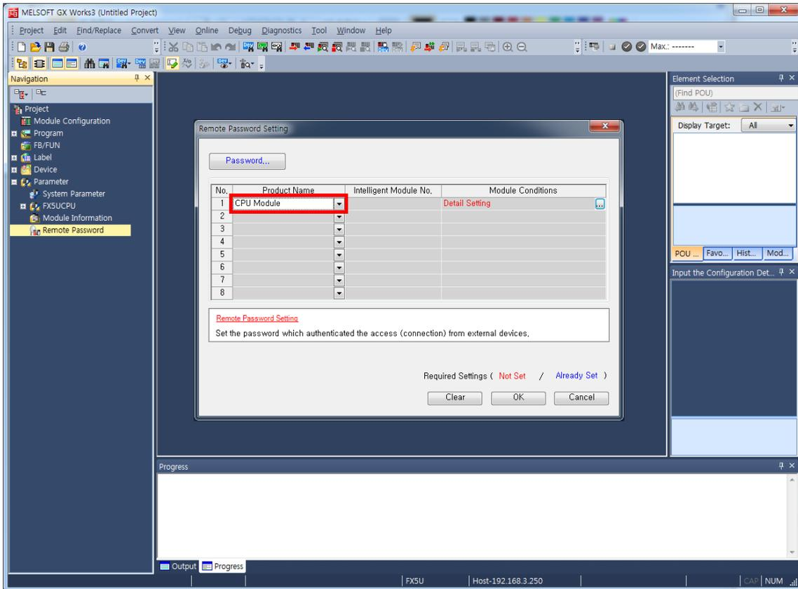
④ Remote Password Detail Setting 창에서 비밀번호를 적용 할 Connection을 선택합니다.
